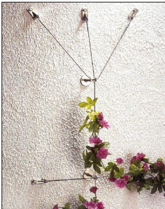
Horní bod připevnění s 3 hmoždinkami a příčně napnutým lanem pro zmírnění vlivu bočního větru.
