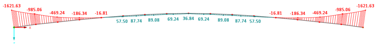
Obrázek 61 Ohybový moment M_y ze stálého zatížení
