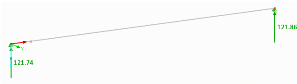
Obrázek 105 Podporové reakce ze stálé kombinace zatížení pro ULS na 1 m
