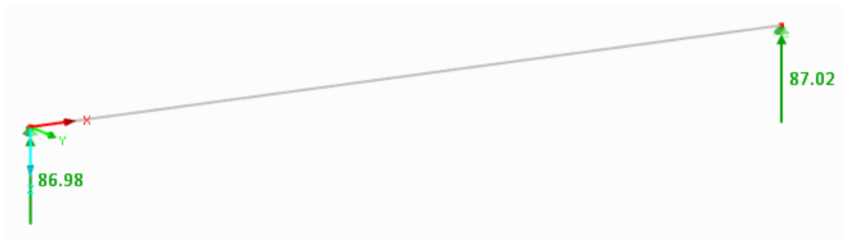
Obrázek 106 Podporové reakce z charakteristické kombinace zatížení pro SLS na 1 m
