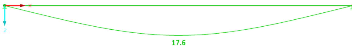
Obrázek 107 Průhyb konstrukce z nelineárního výpočtu pro SLS
