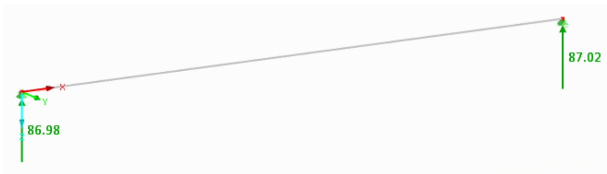
Obrázek 130 Podporové reakce z charakteristické kombinace zatížení pro SLS na 1 m
