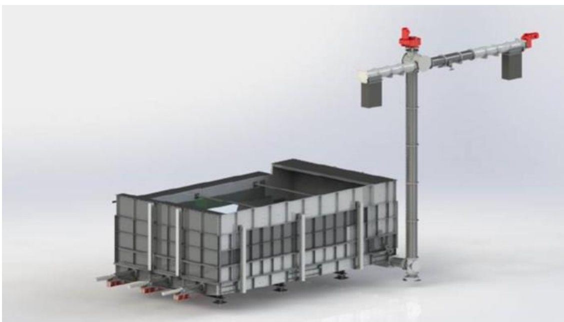
Obr. 10 Kontejnerové provedení bunkru Huning s vyprazdňováním šnekovými dopravníky
