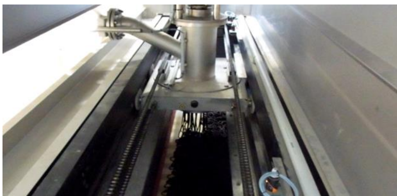
Obr. 11 Distributor kalu na sušící pás ve formě nudlí (Sülzle Klein)
